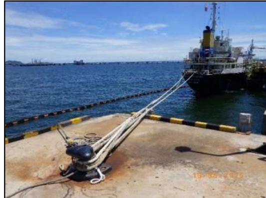
รูปที่ 2-13 การล้อมบูมในขณะสูบน้ำผลิตภัณฑ์
